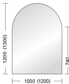
Die Glasbodenplatte Halbrund ist die beliebteste Unterlage bei Wandaufstellung
